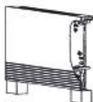
Conexión tubería derecha.
